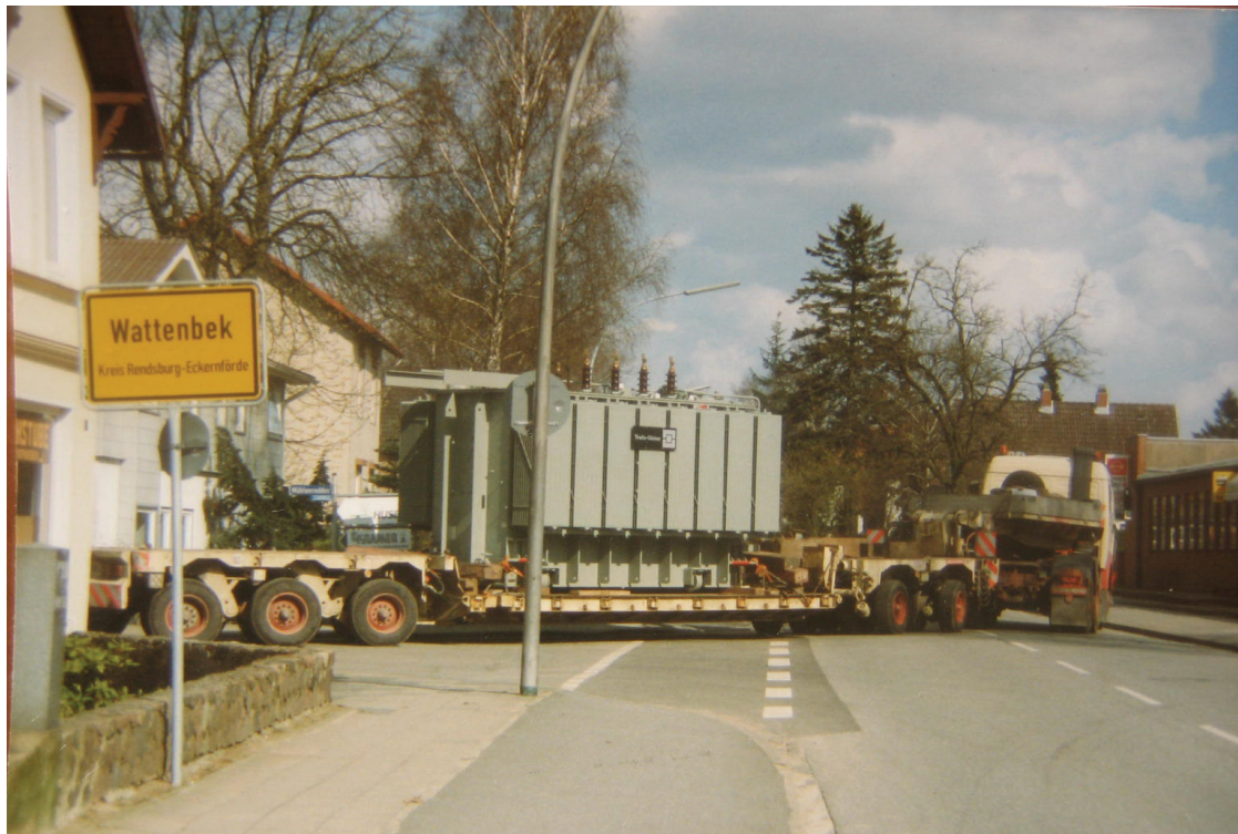
Abb. 28: Umspannertransport vom Bahnanschlussgleis im Mühlenredder bis zum neuen Umspannwerk (1991 oder 1992)
