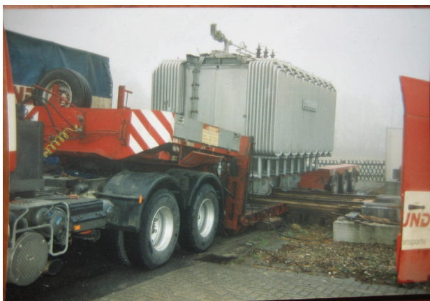
Abb. 26: Umspanner der Firma Schorch mit einem Gesamtgewicht von 43,5 t
